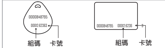
卡片資訊(125kHz) ※ Mifare卡片: 組碼/卡號之間的分隔符號為選號(*)
